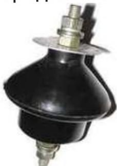
Разрядник РВО, РВН - электротехническое устройство в виде двух или нескольких электродов, разделенных диэлектрическим промежутком. Разрядники используют для защиты электрических сетей и установок от перенапряжений; электрической пробой, возникающий между электродами разрядника, предотвращает пробой изоляции между проводниками.
