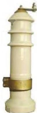
Разрядники РВО предназначены для защиты от грозových перенапряжений изоляции электрооборудования переменного тока частоты 50 Гц с номинальным напряжением 6 и 10 кВ в сетях с изолированной и заземленной нейтралью.
